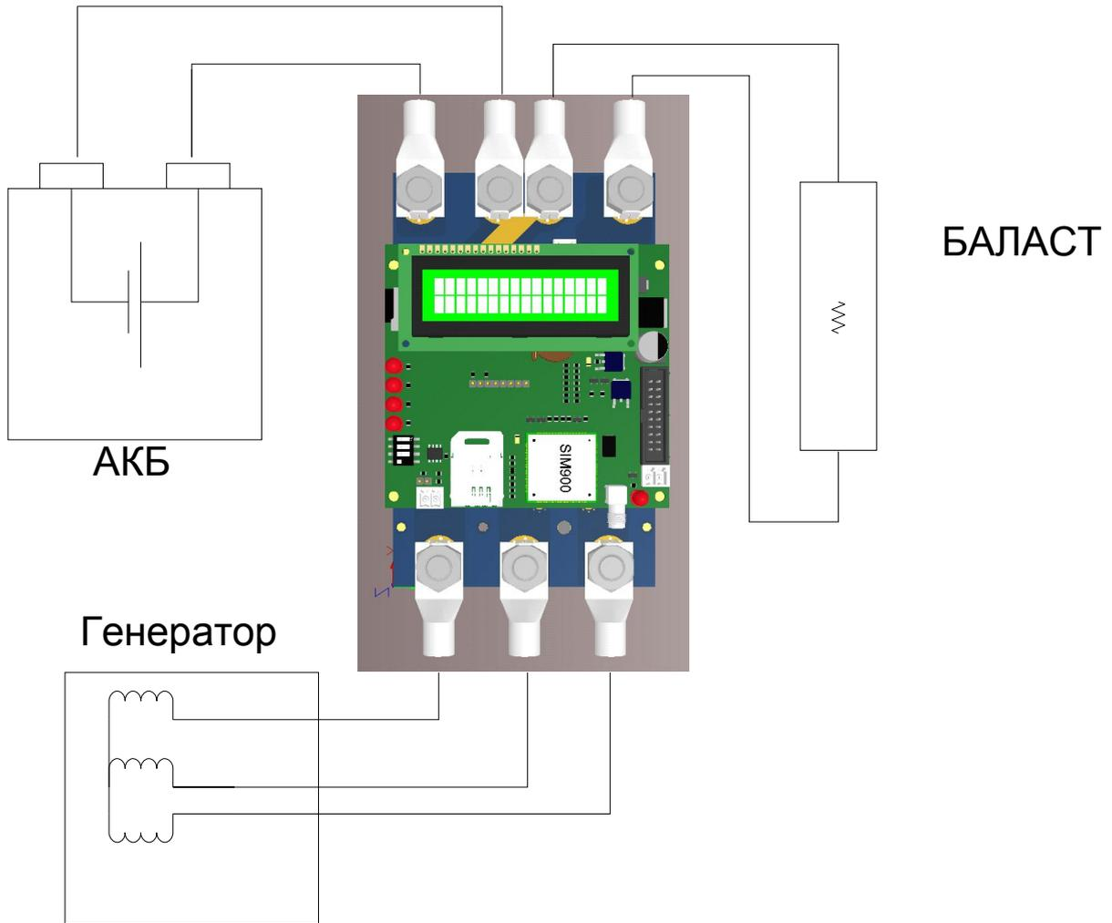
**6. Схема соединения в гидроустановке**
